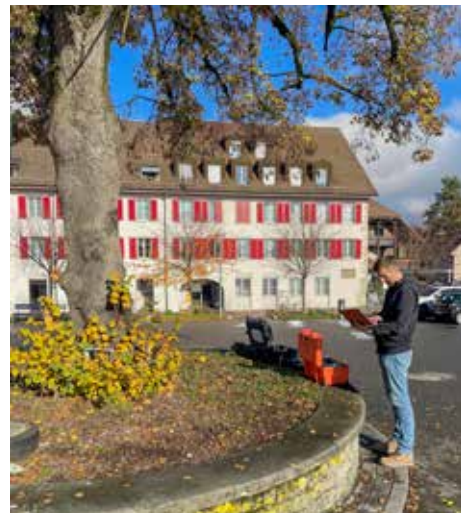
Mittels einer Schalltomographie wurde die Linde auf dem Dorfplatz nach morschen Stellen und Hohlräumen untersucht.
