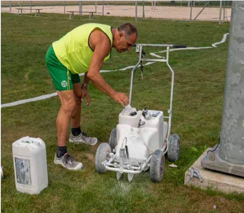
Nach getaner Arbeit muss die Maschine gereinigt werden, damit die Düsen nicht verstopfen.
