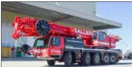
Pneukran Liebherr LTM 1130-5.1
